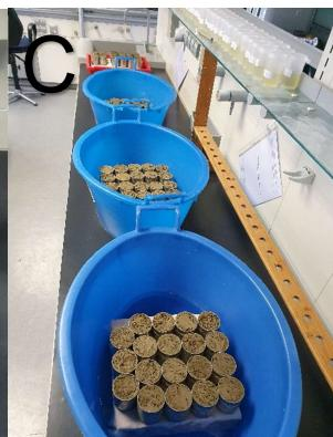
Slika 8. Određivanje fizikalnih svojstava tla: A – uzimanje neporušenih uzoraka tla u polju; B – vaganje uzoraka u laboratoriju; C – postupno postizanje maksimalne zasićenosti uzorka tla vodom (izvor: L. Brezinščak)
