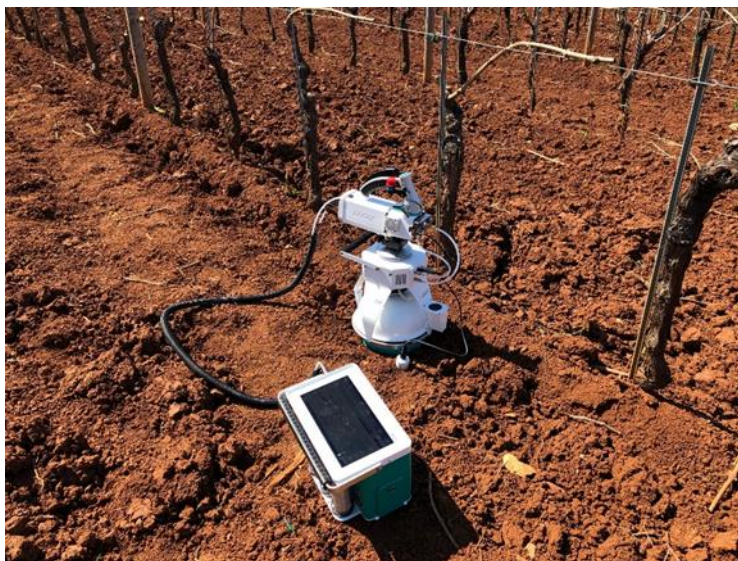
Slika 13. Mjerenje emisija iz tla
