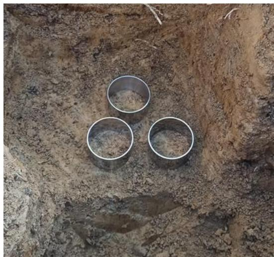
**Slika 3.3.1.1.** Uzorkovanje neporušenih uzoraka tla volumena  $250 \text{ cm}^3$  za procjenu hidrauličkih svojstava tla.
