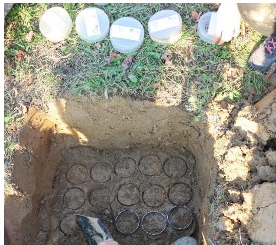
**Slika 3.1.3.** Uzorkovanje neporušenih uzoraka tla volumena  $236 \text{ cm}^3$  na vrhu (A), sredini (B) i dnu (C) padine.
