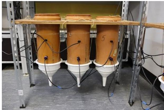
**Slika 3.4.2.** Prikaz kolona s neporušenim tlom u laboratoriju s postavljenim senzorima na dubini od 7 cm i tenziometrima na dubini od 17 cm.
