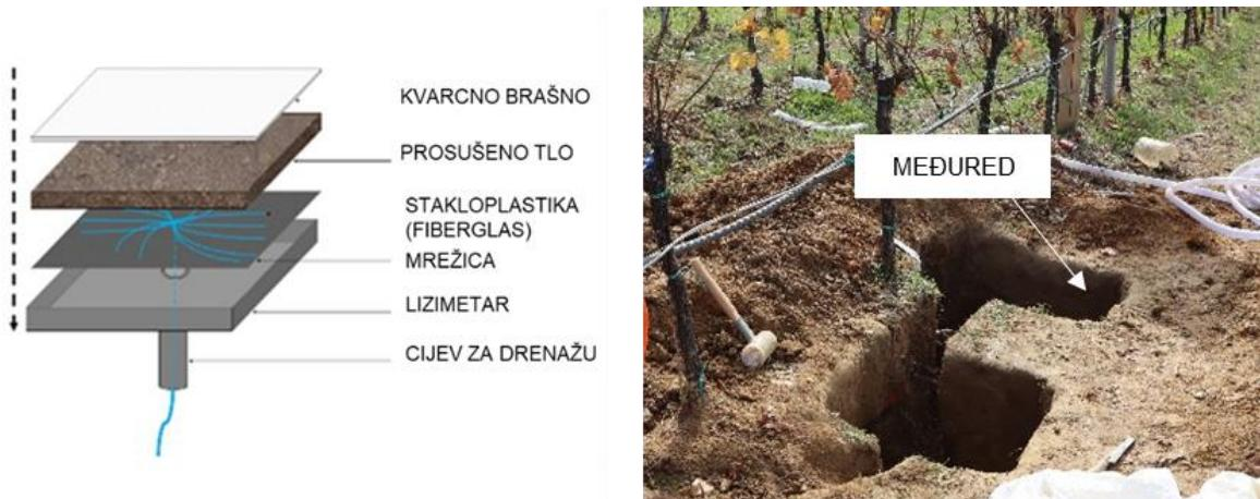
**Slika 3.2.1.1.** Prikaz konstrukcije nevagajućih tlačnih pasivnih lizimetara te njihovo postavljanje na istraživanoj lokaciji.
