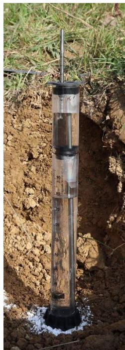
Slika 3.2.2.1. Mjerenje infiltracijske sposobnosti tla mini-disk infiltrometrom.
