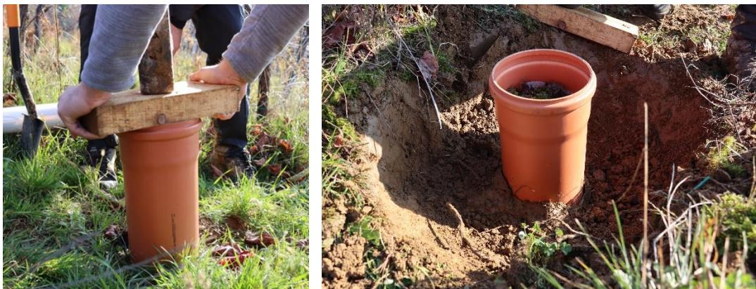
**Slika 3.4.1.** Utiskivanje kolona u tlo i uzimanje neporušenih uzoraka tla na istraživanoj lokaciji.
