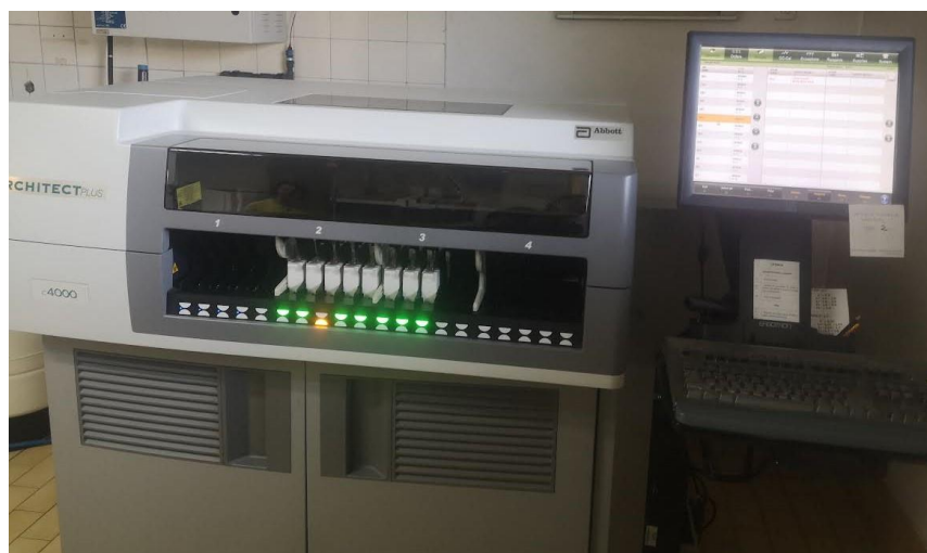
Slika 12. Analizator za mjerenje biokemijskih pokazatelja tkiva Architect c4000
