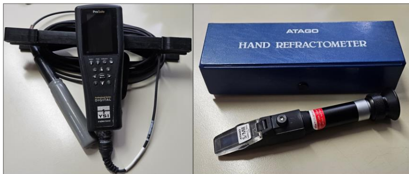
Slika 8. Sonda i refraktometar za mjerenje hidrografskih parametara mora
