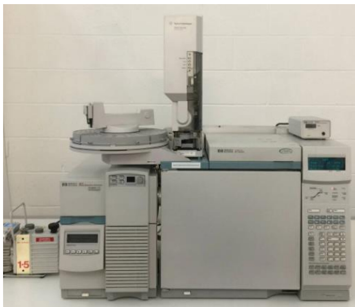
Slika 14. Plinski kromatograf Agilent Technologies 6890N Network GC sustav; izvor: Santa Clara, CA, SAD
