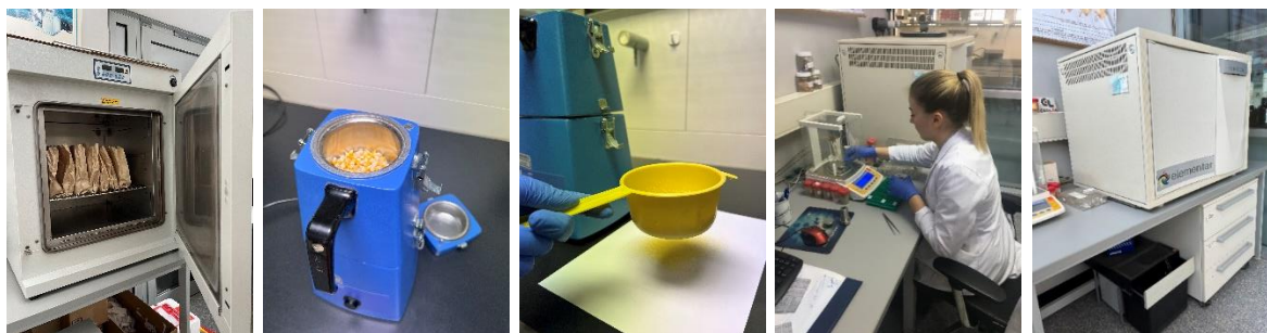
Slika 24. Proces pripreme biljnog materijala za određivanje ukupnog ugljika i dušika (s lijeva na desno: sušenje; mljevenje; prosijavanje i homogeniziranje; vaganje i oblikovanje; tijekom analize u Vario, Macro CHNS analizatoru) (foto: M. Galić; I. Hrelja)
