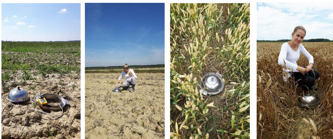
Slika 32. Postupak mjerenja koncentracije ugljikovog dioksida iz tla (foto: M. Galić, I. Hrelja)
