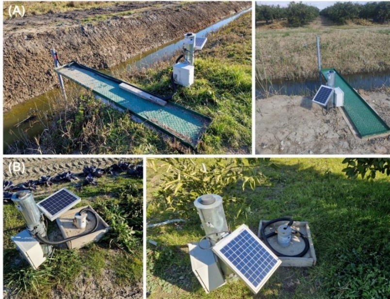
Slika 3.6. Uspostavljeni in-situ kontinuirani monitoring površinskih (A) i podzemnih (B) voda (Izvor: M.Reljić)
