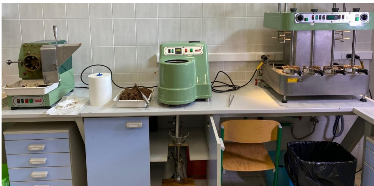
Slika 10. Sustav za preradu ploda masline u laboratorijskom mjerilu Abencor
