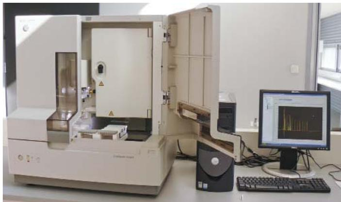
Slika 4.16. Molekularno-genetički laboratorij Zavoda za oplemenjivanje bilja, genetiku, biometriku i eksperimentiranje – automatski genetički analizator ABI-3130 koji se koristi za suvremena istraživanja u području poljoprivredne biotehnologije (Izvor: Arhiva Zavoda za oplemenjivanje bilja, genetiku, biometriku i eksperimentiranje. Autor I. Pejić)
